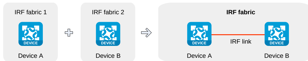
图-2 IRF 合并示意图
