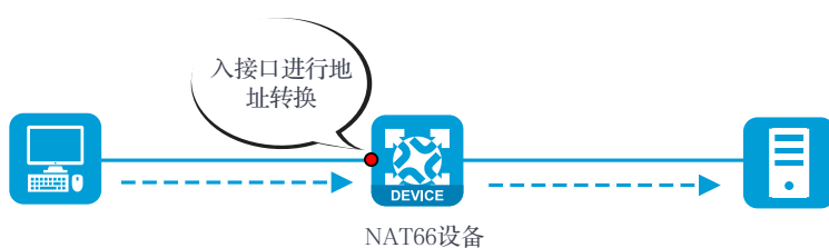
图-1 入接口地址转换示意图
